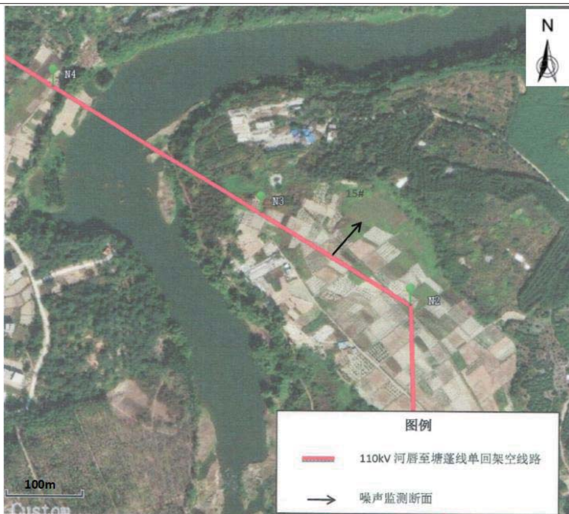
图 4-1 单回架空线路噪声类比监测布点图
