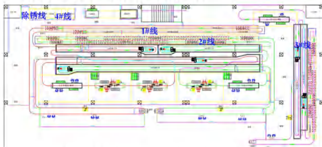
图 7 陶化前处理线、喷粉线及固化工艺设备连接图
