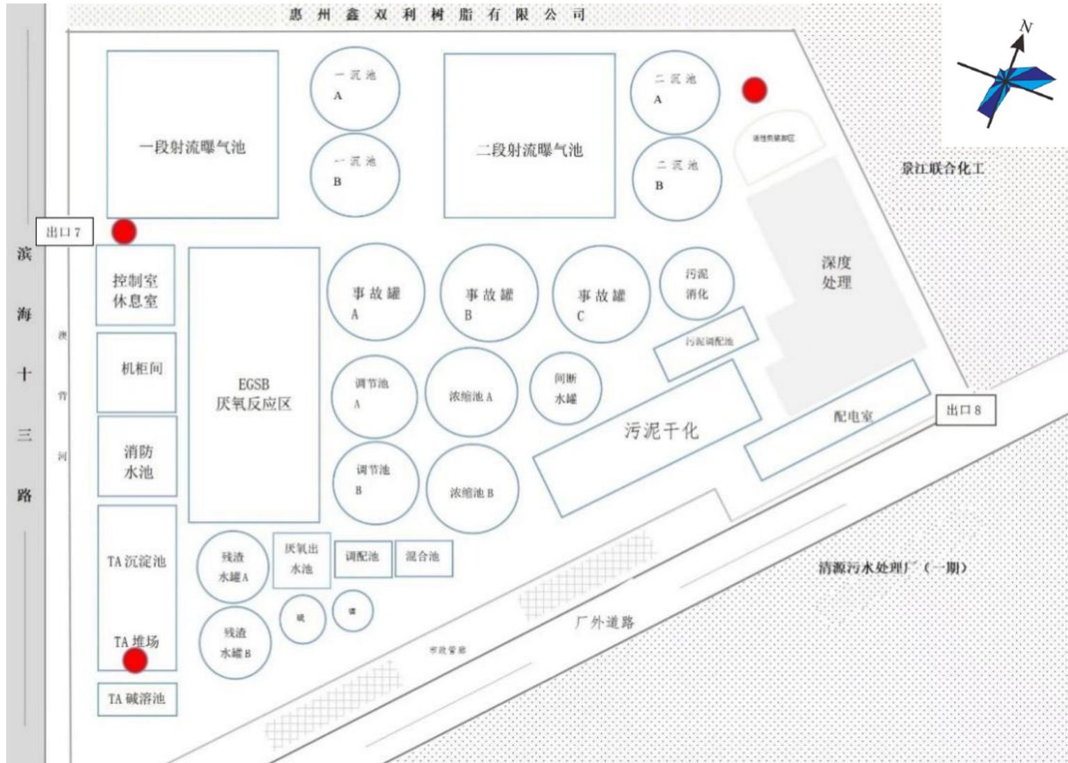
图 2.1-3 污水处理站平面布置图
