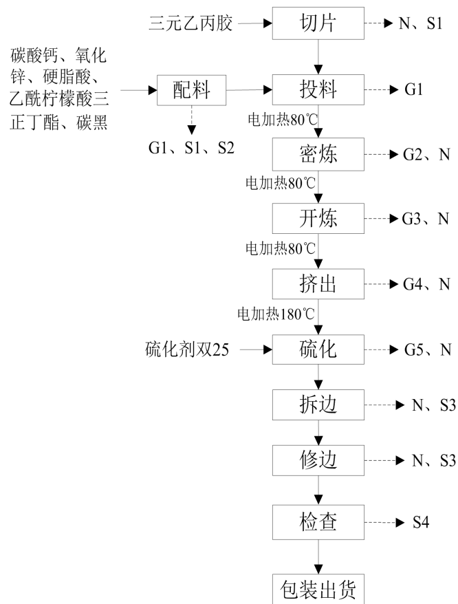
图 3.5-5 非标橡胶产品（橡胶垫）生产工艺流程图
