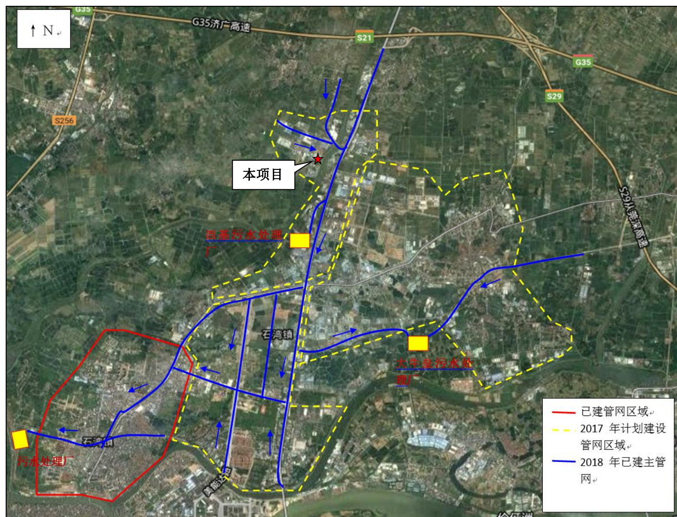
图5.2-1 项目所在地污水管网图
